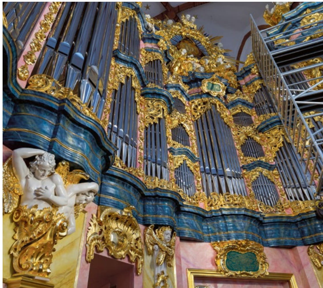
Instrument ma ponad 16 m wysokości i prawie 11 m szerokości (po łuku). Jest wyposażony w 54 głosy, bogato zdobiony rzeźbieniami i polichromią, a także pozłoceny 24 karatowym złotem
